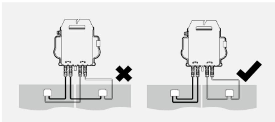
**REMARQUE:** Chaque panneau PV doit être soigneusement connecté au même canal.
