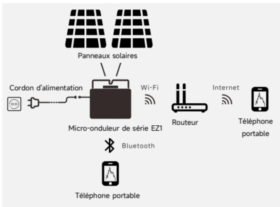
La série EZ1 du micro-onduleur de l'APsystems est utilisée dans les systèmes de balcon et de bricolage qui comprend les éléments clés ci-dessous:
