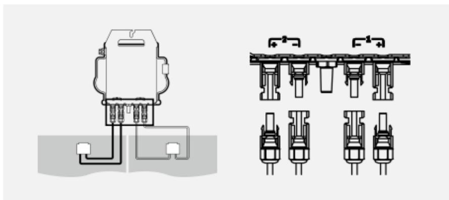
Beim Anschließen der DC-Kabel sollte der Mikrowechselrichter sofort zehnmal grün blinken. Dies geschieht, sobald die Gleichstromkabel angeschlossen sind, und zeigt an, dass der Mikrowechselrichter korrekt funktioniert. Diese gesamte Prüffunktion beginnt und endet innerhalb von 10 Sekunden nach dem Anschließen des Geräts, achten Sie also beim Anschließen der Gleichstromkabel auf diese Lichtsignale.
