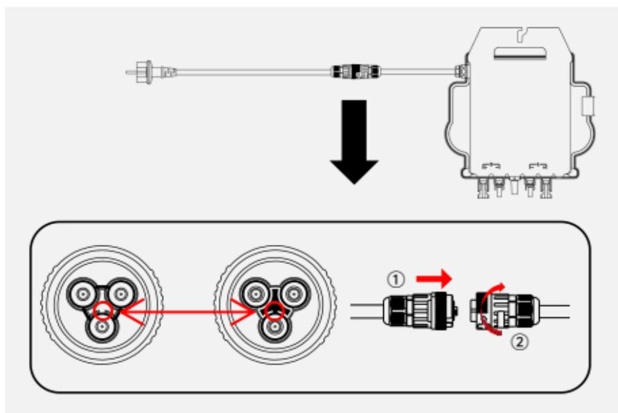
Insérer le connecteur CA du micro-onduleur dans le connecteur du cordon d'alimentation.
