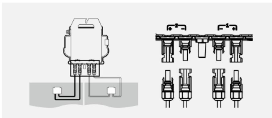
Podczas podłączania przewodów DC, mikroinwerter powinien natychmiast zamigać na zielono dziesięć razy. Nastąpi to w momencie podłączania przewodów DC, wskazując, że mikroinwerter działa prawidłowo. Cała funkcja sprawdzania rozpocznie się i zakończy w ciągu 10 sekund po podłączeniu modułu, dlatego podczas podłączania przewodów DC należy zwrócić szczególną uwagę na światło diody LED.
