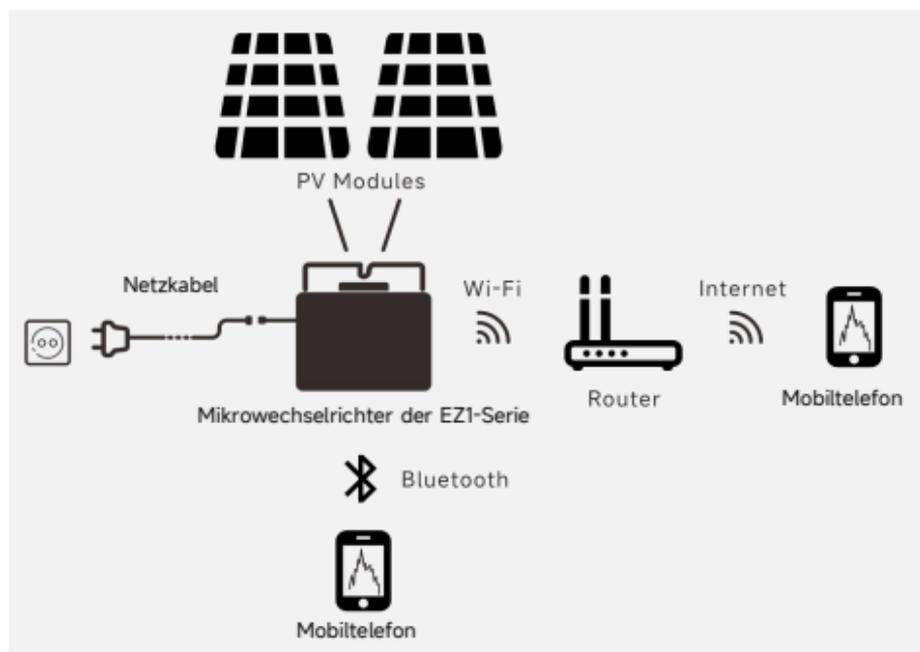
Der Mikrowechselrichter der EZ1-Serie von der APsystems wird in Balkon- und Heimwerkeranlagen eingesetzt, die aus den folgenden Schlüsselementen bestehen:
