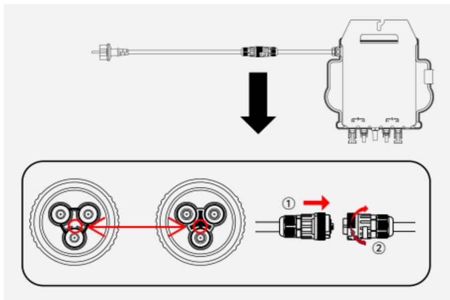
Należy podłączyć złącze AC mikroinwertera do złącza przewodu zasilającego.
