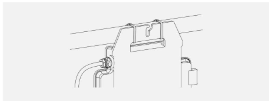
A. Marquer l'emplacement du micro-onduleur sur la balustrade du rack ou du balcon, par rapport à la position appropriée.
