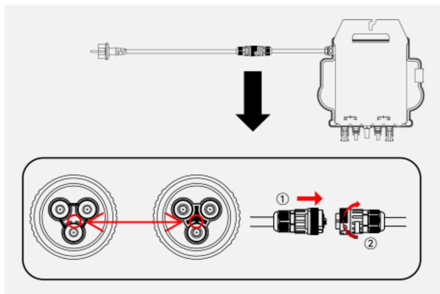
Führen Sie den AC-Stecker des Mikrowechselrichters in den Netzkabelanschluss ein und ziehen Sie die Überwurfmutter fest.
