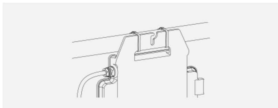
Mikroinwerter EZ1 można instalować na ścianie balkonu lub mocować do balustrady za pomocą opasek kablowych. Aby zapewnić bezpieczną instalację mikroinwertera EZ1, należy wybrać odpowiednią metodę instalacji, opartą na rzeczywistym scenariuszu użytkownika.
