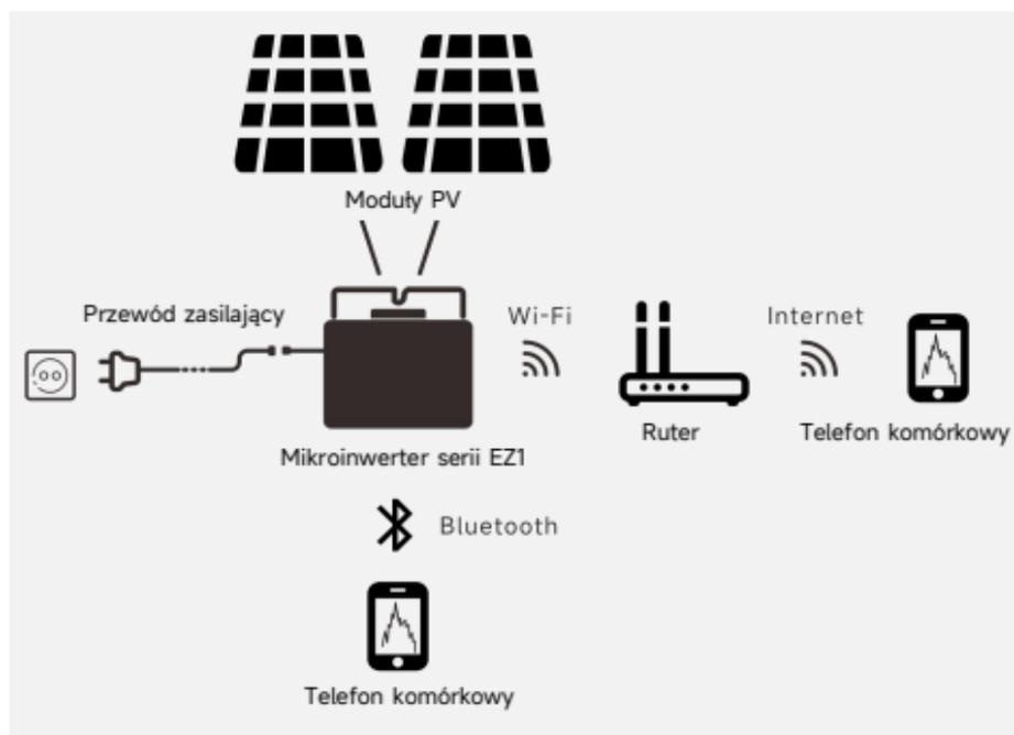
Mikroinwerter APsystems serii EZ1 jest stosowany w systemach balkonowych i do samodzielnego montażu (DIY) i składa się z następujących głównych elementów:
