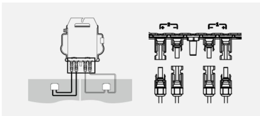
Lors du branchement des câbles CC, le micro-onduleur doit immédiatement clignoter en vert dix fois. Cela se produit dès que les câbles CC sont branchés et indique que le micro-onduleur fonctionne correctement. Cette fonction de vérification complète démarre et se termine dans les 10 secondes suivant le branchement de l'unité, donc faites attention à ces voyants lors du branchement des câbles CC.
